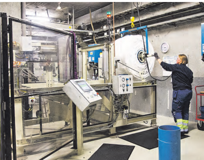
Packningen av 700-kilossäckarna med utsäde är automatiserad. Operatören Anna Johansson byter rulle trycker på start igen.
