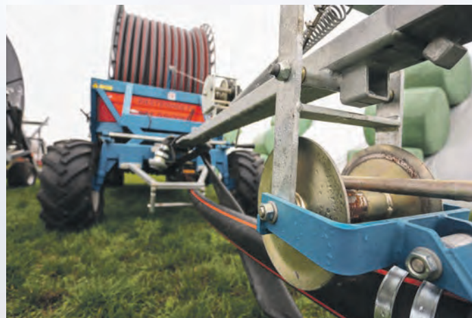
Den danska bevattningsmaskinens framhjul styrs med hjälp av en rulle som följer den utmatade slangen.
