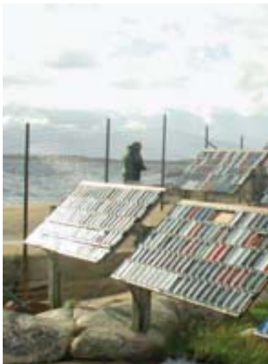
En ny miljövänlig lackfärg med RME (rapsmetylester) istället för lösningsmedel baserat på råolja testas i väder och vind på svenska västkusten, i Borlänge och i Florida.
